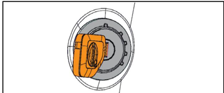
2. Vypněte spínač LNG na zadní straně nádrže LNG, čím vypnete čerpadlo LNG.
