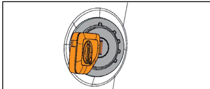
2. Apague el interruptor de GNL en el extremo posterior del depósito de GNL para desactivar la bomba de GNL.
